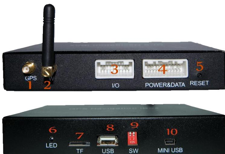
1. Соедините кабелем блок навигации(разъем 4) и магнитолу (на задней панели ресивера PIONEER должен быть соответствующий разъем RGB)
